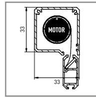
Einteilige, vierseitig geschlossene Aluminiumkassette mit Kammer zur Bürstenaufnahme, Querschnitt 33 x 33mm mit seitlich verschraubten Kunststoffendkappen. Wickelwelle und Abschlussprofil aus stranggepresstem Aluminium, Abschlussprofil mit Kammer zur Bürstenaufnahme und
